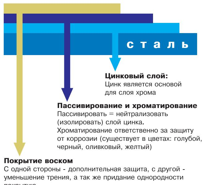
**Это трехслойная антикоррозионная защита, нанесенная гальваническим методом:**
