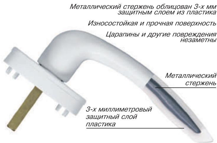
Все ручки MACO представляют собой металлический стержень, покрытый 3 мм защитным слоем пластика. Специальный высококачественный пластик обеспечивает высокую износостойкость, эластичность хода и длительный срок работы (по результатам испытаний, даже после 20 000 циклов поворота, обеспечивается надежная фиксация оконной ручки в заданном положении).
